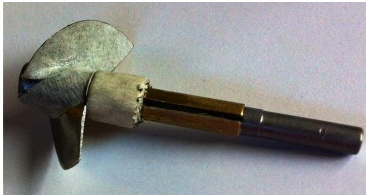
3. Propeller abkleben (z.B. mit Kreppklebeband), auf einen Dorn schrauben / schieben und Hülse stramm drauf schieben.
