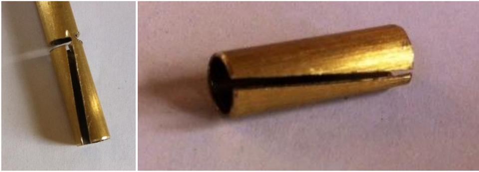
1. Passendes Rohr schlitzten und abtrennen (links) anschließend
